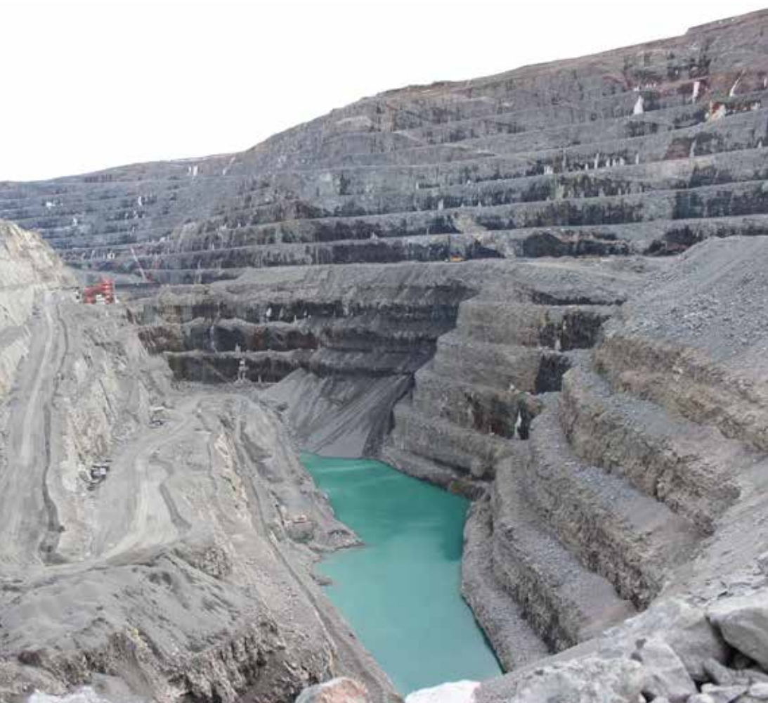
Bolidens koppargruva Aitik, Gällivare är en av Europas största. Låga metallhalter innebär att enorma ytor tas i anspråk. Dagbrottet är ca 3 km 2 och avfallsdammarna ca fyra gånger så stora. Foto: Magnus Stromseth.
